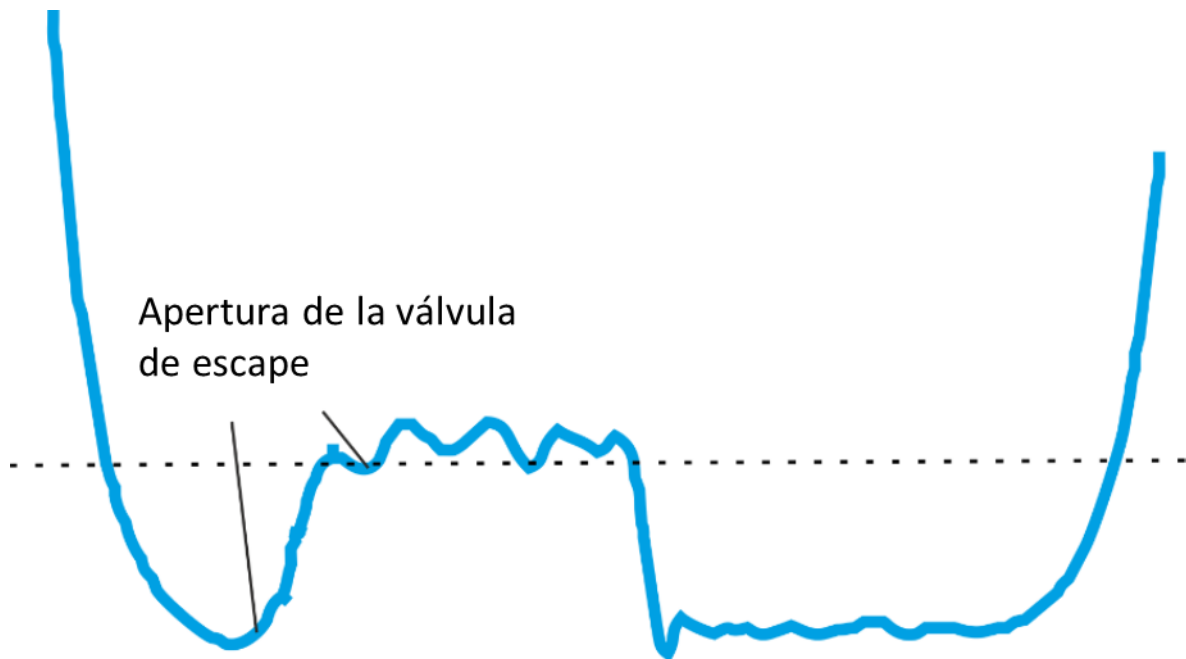
Figura 3. Guías de válvulas de escape gastadas indicadas aquí por los pulsos
